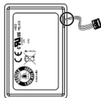
**4** Inserte el conector del paquete de batería nuevo en la terminal PCB presionándolo hacia abajo.
